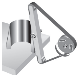
Dem Winkel angepasstes Schleifen der Schneiden
